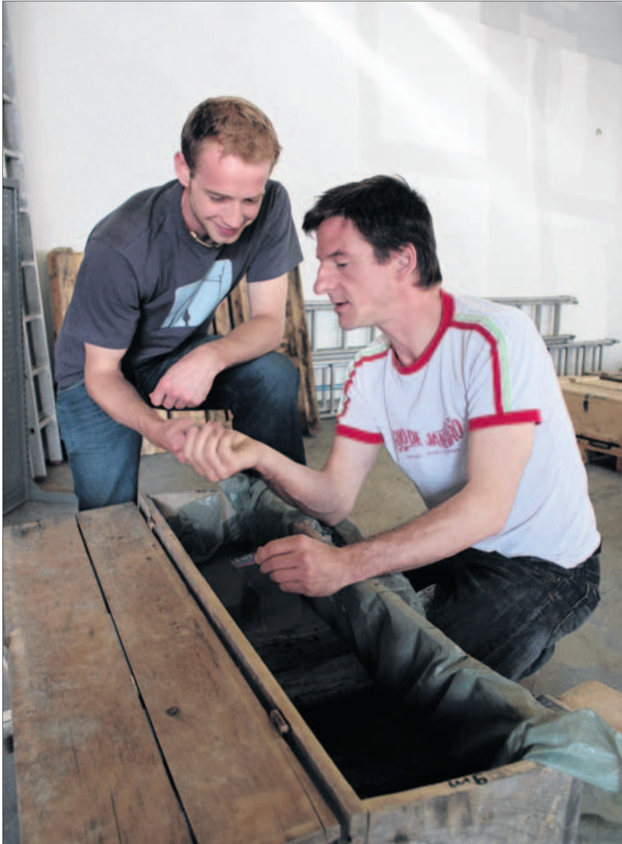
Hans Axel Kemna (rechts) untersucht mit dem Geologie-Studenten Andreas Züger den Bohrkern aus 9 Meter Tiefe. (dma)
